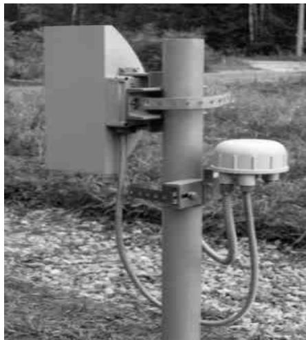
*Рис. Датчик серии РЛД-94*
